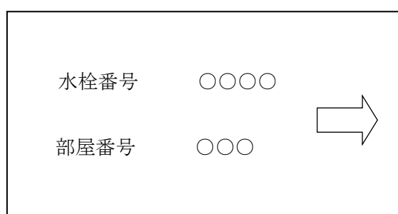
別図第 36 <メーターボックス蓋裏面図>
