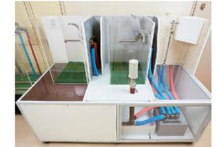
ヘッダ方式による水・湯混合栓の模型
