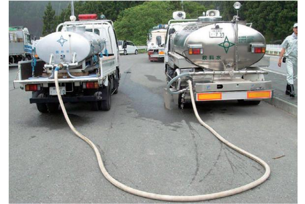
4t 車から 1.5t 車に補水を行い、道幅の狭い地域での給水に対応
