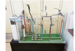
給湯器がついた水・湯混合栓の模型
