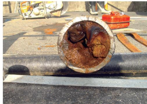
錆により閉塞した水道管
