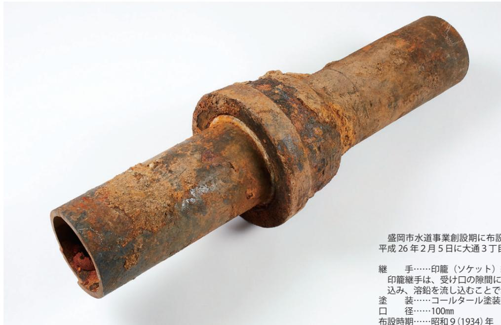
盛岡市水道事業創設期に布設された高級铸铁管である。平成 26 年 2 月 5 日に大通 3 丁目地内から掘り上げ。
