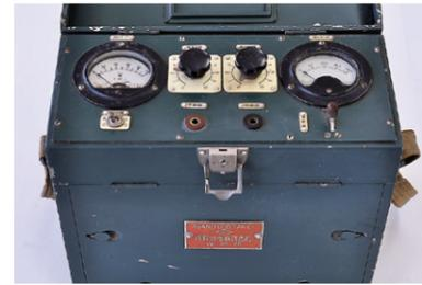
昭和24年に製造された漏水発見器(漏水探知器) 昭和24年度から導入された
