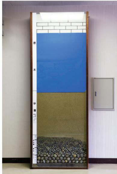
緩速ろ過池の構造模型
