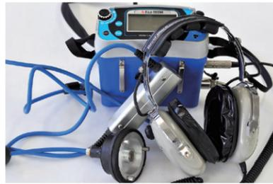
現在は、調査の妨げになる騒音を除去するノイズカット方式を採用した漏水探知器を使用
