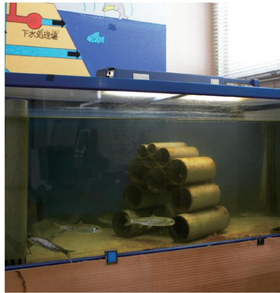
米内川の原水を観測している水質監視水槽
