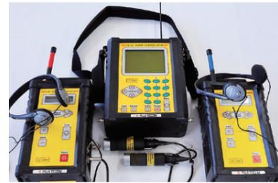
現在使用しているポータブル式の相関式漏水探知器(性能向上により夜間のみでなく日中も調査が可能に)
