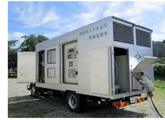
移動電源車を配備し、停電時も電力を確保
